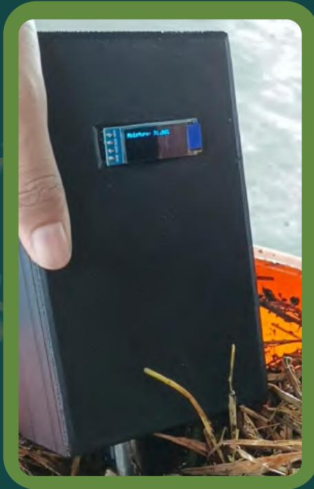
4. Amati hasil pengukuran pada OLED display untuk menentukan kondisi kelembapan kompos. Data yang ditampilkan dapat membantu untuk menentukan apakah kompos membutuhkan penyiraman tambahan atau sudah cukup lembap.
